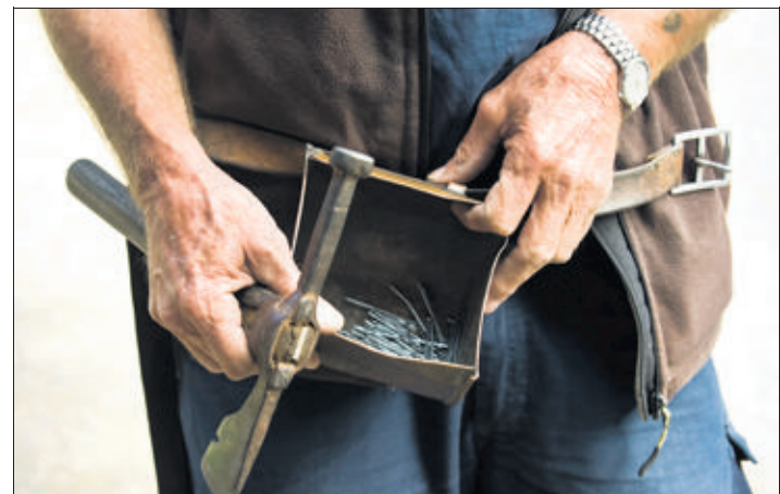
La martèle. A la fois marteau, tire-clou et hachette pour les finitions, c'est l'outil principal du taviillonneur. Elle est fabriquée à la pièce et sur mesure par des forgerons. La caissette à clous est indispensable.
